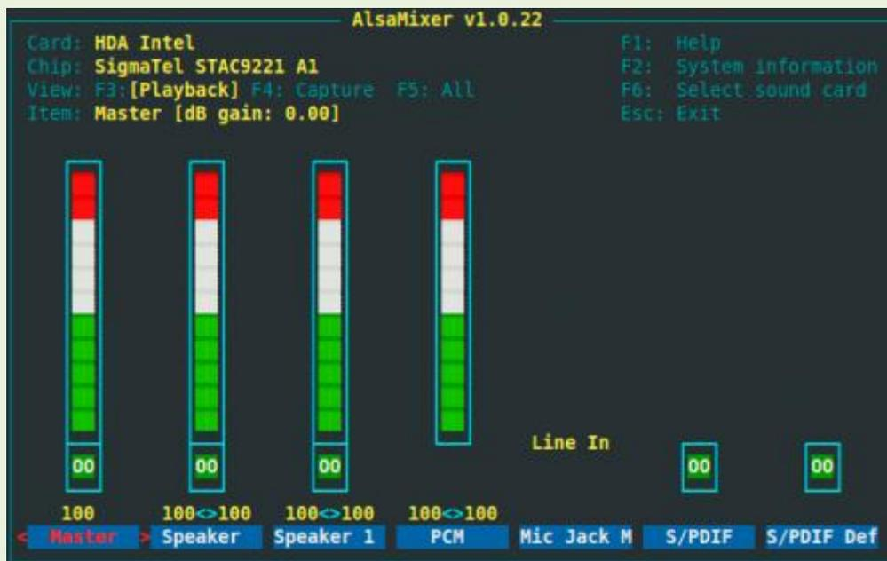
Mediante esta herramienta de consola podremos modificar todos los parámetros de volumen de nuestra tarjeta de sonido, utilizando las flechas de navegación. Para salir pulsaremos ESC (Escape)
